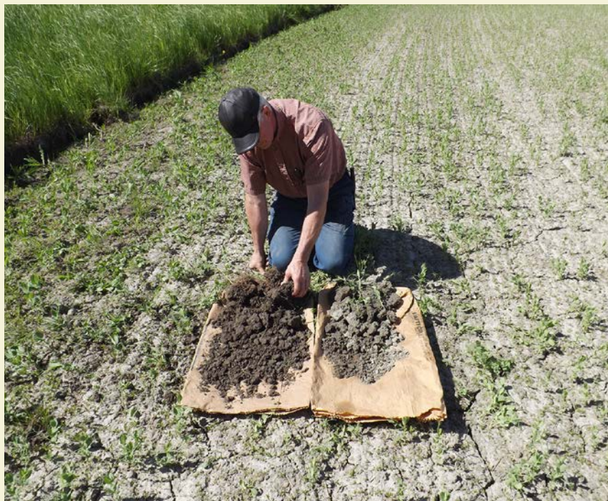
Ei spadeprøve vil raskt avsløre om jorda er pakket. Prøven til venstre er fra kjørefri åkerkant. Prøven til høyre er tatt inne på jordet. Foto: Øystein Haugerud.
