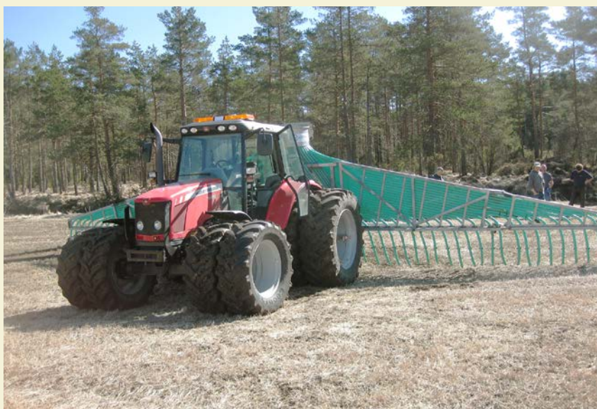
Slangespredning av husdyrgjødsel med tvillinghjul gir svært lav jordbelastning. Foto: Jan Karstein Henriksen
